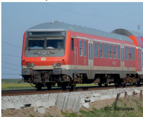
**Vorbild:** Nahverkehrssteuerwagen Bauart Bnrbdzf 480.1 in verkehrsroter Farbgebung der Deutschen Bahn AG (DB AG).
