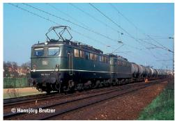
Vorbild: Schwere Güterzuglokomotive 150 113-9 der Deutschen Bundesbahn (DB). Farbgebung chromoxidgrün. Größte Bauart der Einheits-Elektrolokomotiven aus dem Neubauprogramm der 50er-Jahre. Version des 2. Ablieferungszustandes mit wenigen Bauartänderungen, z.B. Maschinraumfenstern. Betriebszustand um 1991.
