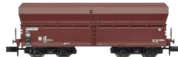
*Bis heute ist Kohle ein wichtiger Rohstoff für die Stahlindustrie und Elektrizitätsgewinnung geblieben. Die Versorgung der Hochöfen und Kraftwerke mit den benötigten Mengen wird über weite Strecken durch Binnenschiffe und die Bahn abgewickelt. Zum Einsatz kommen dabei vor allem Ganzzüge aus sogenannten Seitenentladewagen, die über spezielle Vorrichtungen automatisch be- und entladen werden können.*
