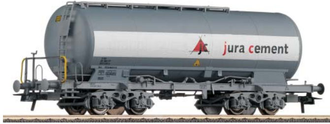
Zementsilowagen der Jura-Zement, eingestellt bei den SBB.
