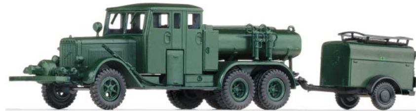
LKW Henschel Tankspritze Ts 2,5 der Feuerlöschpolizei mit Ts-Anhänger.
