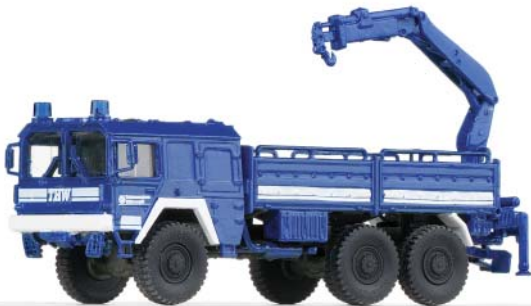
LKW MAN 7t mit Kran des THW.
