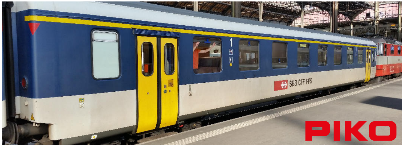
Der Einheitswagen Typ I, EW I ist der am meisten eingesetzte Personenwagen im Schweizer Schienennetz.
