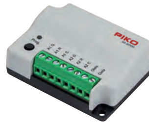
55032 PIKO SD 2000 Schaltdecoder zum Schalten von Magnetartikeln (z.B. Weichen).
