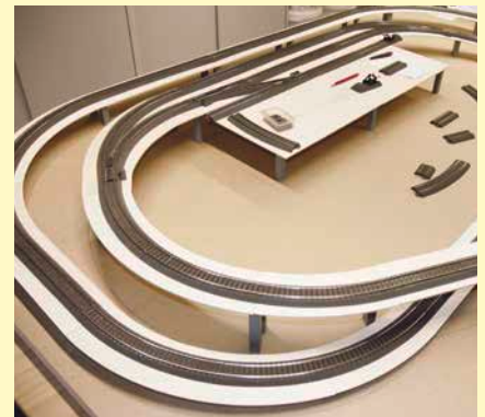
6. Die Schienen werden auf die Gleistrasse aufgelegt.
