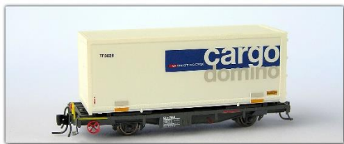
Nm-013.4: RhB Lb-v 7861ff., Tragwagen mit cargo domino-Wechselbrücke (Fleischmann), Metallmodell für Nm (6,5mm)
