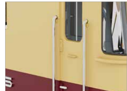
■ Griffstangen an den Aufstiegen aus Metall
