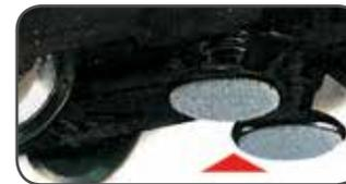
Die Lokomotive besitzt durch den Motor angetriebene, rotierende Reinigungsscheiben. So bleiben die Schienen ohne Flüssigkeit sauber. Ersatz-Schleifscheiben: 357969.
