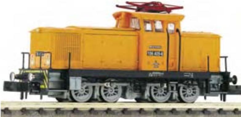
Der auf dem Dach ohne Isolatoren befestigte Stromabnehmer diente nur Messzwecken bei Errichtung und Kontrolle von Fahrleitungen. Mit Hilfe des Messbügels konnte die Lage des Fahrtdrahtes bestimmt werden.
