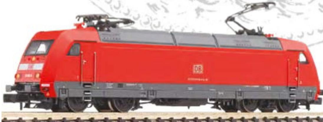
**735500** Elektrolokomotive BR 101 der DB AG, Ep. VI, mit Digitalschnittstelle
