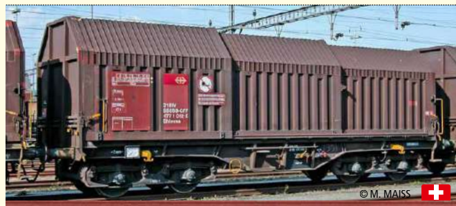
Teleskophaubenwagen Shimms SBB Betriebs-Nr. 31 81 466 9 011-6
