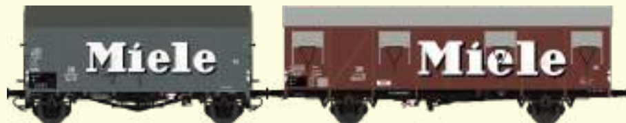
Gedeckter Güterwagen Gms 30 "Miele" der DB
