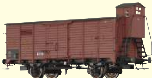
Gedeckter Güterwagen Gm der K.Sächs.Sts.E.B. Betriebs-Nr. 23 930
