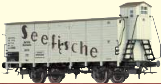
Kühlwagen Gkh "Fischwagen" der DRG Betriebs-Nr. 212
