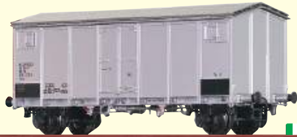
Spitzdachwagen lms „Kühlwagen“ der FS Betriebs-Nr. 11 83 813 1 125-7
