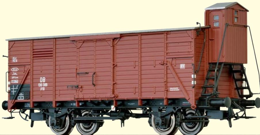
**Gedeckter Güterwagen G 10 der DB, mit Handbremse**
