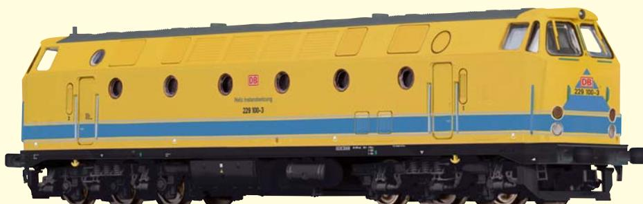
Die Deutsche Reichsbahn beschaffte ab 1977 aus Rumänien 200 Dieselloks der Reihe 119. Die sechsachsigen Maschinen hatten zwei getrennte Maschinenanlagen mit hydraulischer Kraftübertragung. Es wurden rumänische Lizenzbauten eines MTU-Dieselmotors mit 990 kW Leistung verwendet. Die Achslast von 16 t ermöglichte einen Einsatz auf Nebenstrecken. Wegen der sechs runden „Bullaugen“ an den Seitenwänden erhielten die Lokomotiven den Spitznamen „U-Boote“.
