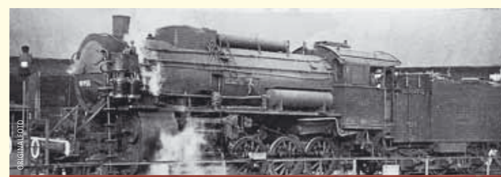
Güterzuglok G 4/5 H der SNCF Das schräg geneigte Vierzylinder-Triebwerk der G 4/5 H war mit einem filigranen Barrenrahmen kombiniert. Der Kessel, bei dem das damals recht neue Heißdampfverfahren nach Schmitt Verwendung fand, war sehr leistungsfähig. Dank des ausgeglichenen Vierzylinder-Triebwerkes war trotz der nur 1270 mm großen Treibräder die Höchstgeschwindigkeit von 60 km/h problemlos ausfahrbar. Die Lok hatte große Zugkraft, sie zog 1000 t auf einer 11 %-Rampe mit 18 km/h. LIEFERTERMIN: 3. QUARTAL 2012
