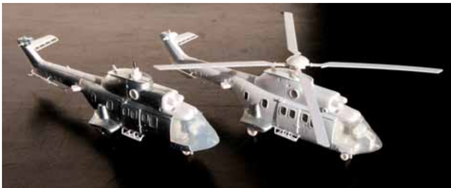
Letzte Kontrolle am Resinmodell und dem ersten Spritzgussmodell aus Metall.
