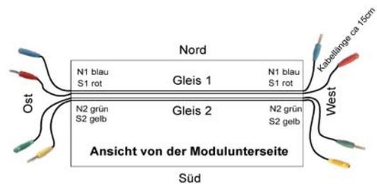
Abbildung 36: Streckenmodul, Ansicht von unten
