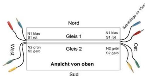
Abbildung 35: Streckenmodul, Ansicht von oben
